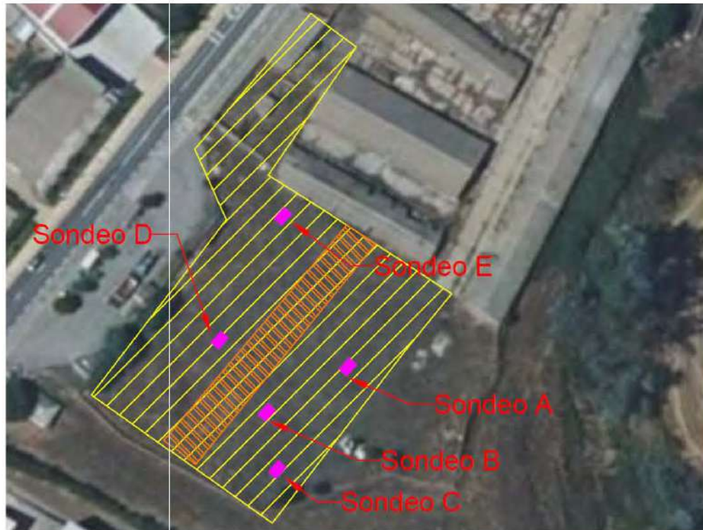
Distribución de los sondeos comprobatorios en las dos bandas desbrozadas en la parte meridional del sector.
